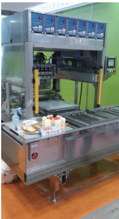
超音波カッターを含めた処理工程のソリューション提供をした機械
