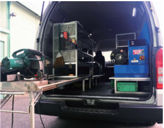
「移動ホースアッセンブリー車」。お客様の工場や現場に急行し、その場で必要な高圧ホースを製作できる
