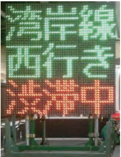
夜間工事の安全を守る表示用掲示板
