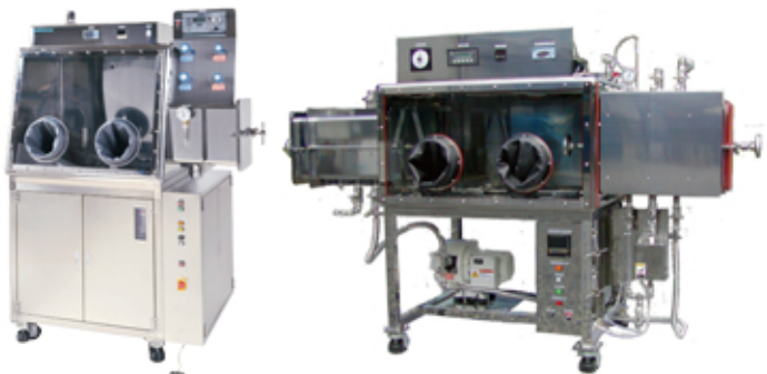
低水分・低酸素状態をコントロールできる 「不活性ガス循環精製装置付グローブボックス」
