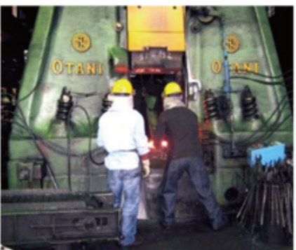
巨大なエアスタンプハンマーも熟練した職人でこそ輝きを放つ
