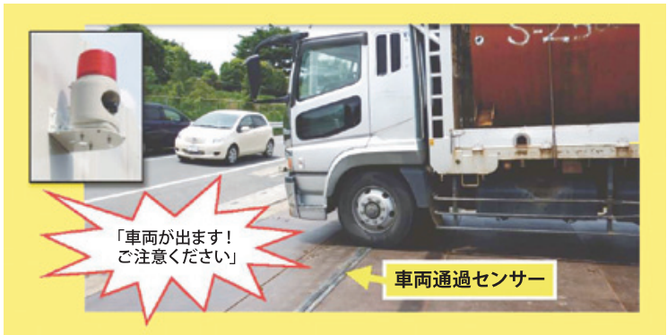
「車両通過検知システム」空気圧センサーのイメージ図
