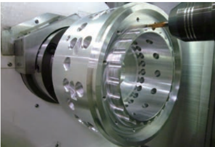
φ230の複合加工を施した自動車塗装用産業ロボットの部品
