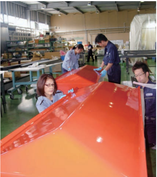
レーダーなどを雨雪から守るGFRP製カバー
