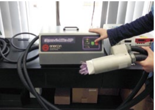
UVインクジェット印刷時に使用するプラズマ発生装置
