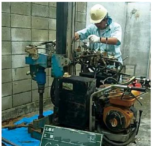
ボーリング調査での土壌試料採取の様子 (自社製造機による掘削)
