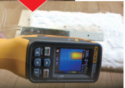
塗料が塗られた部分だけ、放熱しているのが分かる
