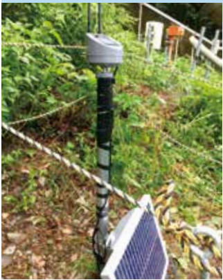
↓電力会社向け傾斜センサ設置状況
