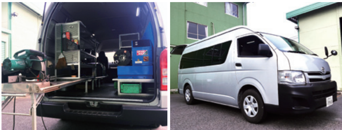
「移動ホースアッセンブリー車」。お客様の工場や現場に急行し、その場で必要な高圧ホースを製作できる
