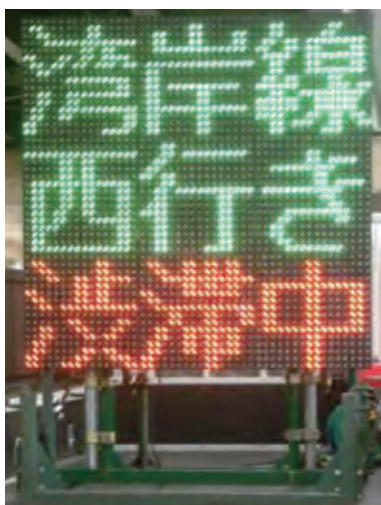
夜間工事の安全を守る表示用掲示板
