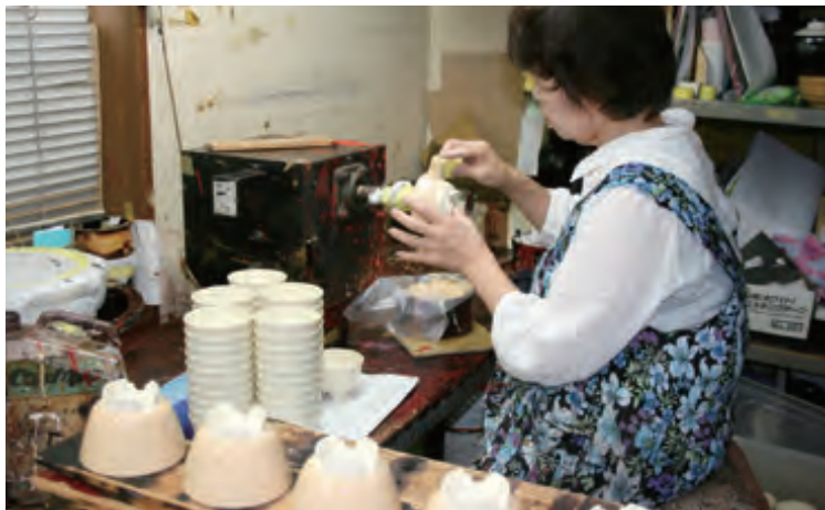
塗りの工程は、職人が一つひとつ手作業で行っている
