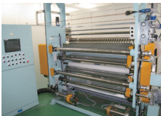
スリット幅自動設定機能搭載のスリッター
