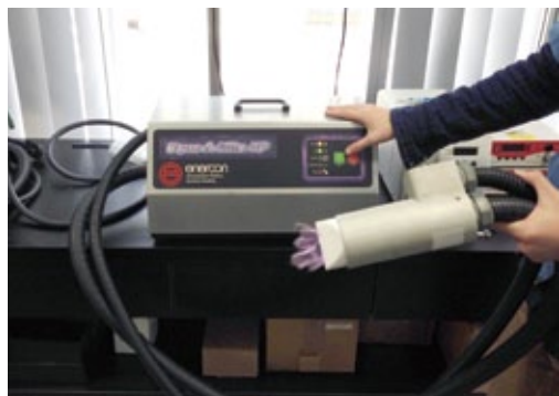
UVインクジェット印刷時に使用するプラズマ発生装置
