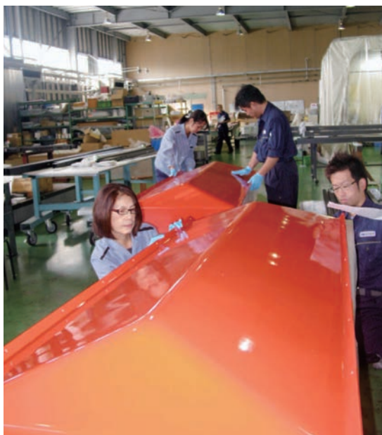
レーダーなどを雨雪から守るGFRP製カバー
