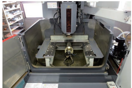
このワイヤー放電加工機で鉗子を製作する
