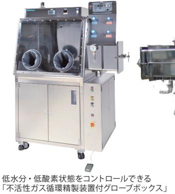
低水分・低酸素状態をコントロールできる「不活性ガス循環精製装置付グローブボックス」
