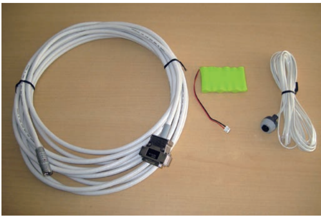
左から医療用コネクタ、バッテリー、ナースコール。製品は多岐に亘る
